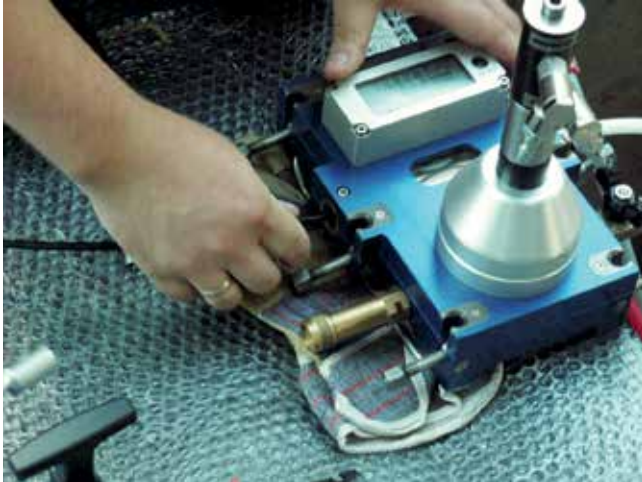
Fot. 11. Wdmuchiwanie mikrokabla MKLX6 (sztywny mikrokabel o średnicy 5,8 mm, liczba włókien od 12 do 72) do Novomicro 10/8 – zdjęcie udostępnione przez P.H. ELMAT Sp. z o.o.
